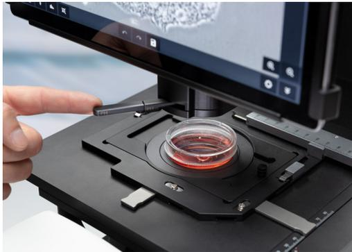
Über den Kontrastschieber schalten Sie unkompliziert zwischen Phasenkontrast und Hellfeld um.
