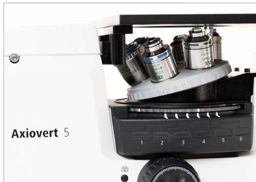
Der kodierte Revolteller mit Haltern für sechs Objektive sorgt für präzise Daten. Auch der genutzte Filtersatz wird automatisch erkannt.
