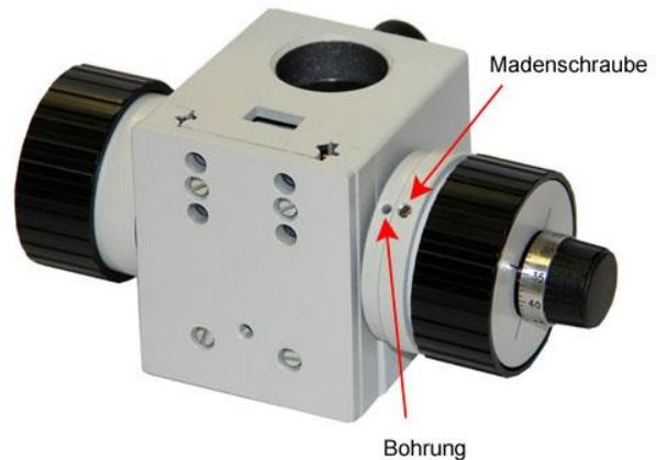
Bild 3.1: Änderung des Schwerganges vom Grobtrieb (beim Grob- und Feintrieb)
