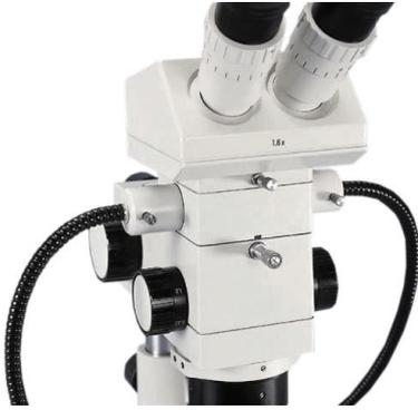
Bild 13: Hellfeld – Auflichteinrichtung Kaltlicht
